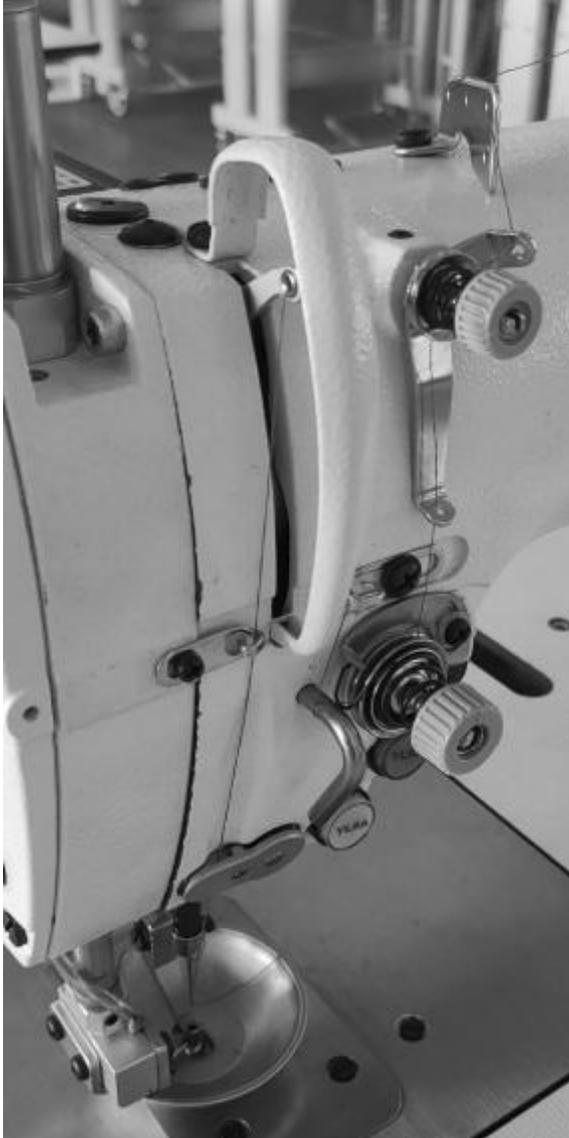
在穿引面线之前先转动手轮，将挑线杆(1)置于最高位置。这样会使穿引更加容易，并防止面线在缝纫开始时脱落。
